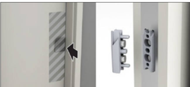
Em caso de emergência, se não puder remover a maçaneta da porta na parte interna da dobradiça, abra a porta com força, aplicando uma força séria ao redor da área da alça. Com 1 kN de força, o clipe de segurança na trava irá ceder e a porta se abrirá /
