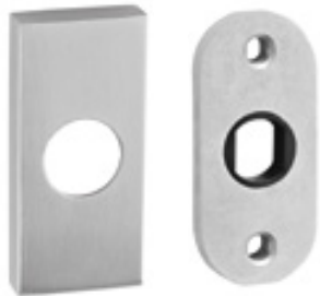
RT32M Roseta com base metálica fundida de liga de zinco, resistente à corrosão com mola compensadora reversível, blindada, anti-fricção e anti-ruído. O puxador não está fixo à base, pode ser removido. Modelo JNF patenteado / Metallic base made in zinc alloy, with two ways returning spring, no friction and no noise. The spring it's in a closed and protected box. The handle it's not fixed to the base, can be removed. Patented JNF model / Roseta con base metálica, en aleación de zinc con muelle reversible blindada sin fricción y sin ruido. La manilla no está fija a la base. Modelo patentado. JNF.
