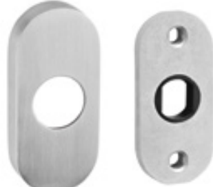
O32M Roseta com base metálica fundida de liga de zinco, resistente à corrosão com mola compensadora reversível, blindada, anti-fricção e anti-ruído. O puxador não está fixo à base, pode ser removido. Modelo JNF patenteado / Metallic base made in zinc alloy, with two ways returning spring, no friction and no noise. The spring it's in a closed and protected box. The handle it's not fixed to the base, can be removed. Patented JNF model / Roseta con base metálica, en aleación de zinc con muelle reversible blindada sin fricción y sin ruido. La manilla no está fija a la base. Modelo patentado JNF.
